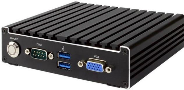
**СПАРКС JW691** - Малогабаритные промышленный ПК СПАРКС с пассивным охлаждением может использоваться для встраиваемых компьютерных комплексов (банкоматы, платежные терминалы и т.п.), а также для мобильных бортовых систем. Решения СПАРКС являются высокопроизводительными компьютерами с пониженным энергопотреблением, широким диапазоном напряжения электропитания, а также предусмотрены различные возможности монтажа корпуса устройства. Для каждой модели предлагается несколько базовых конфигураций.
